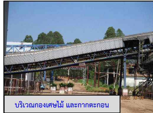
ภาพที่ 2.3 สายพานลำเลียงระบบปิด บริเวณลำเลียงถ่านหิน เศษไม้ และกากตะกอน
