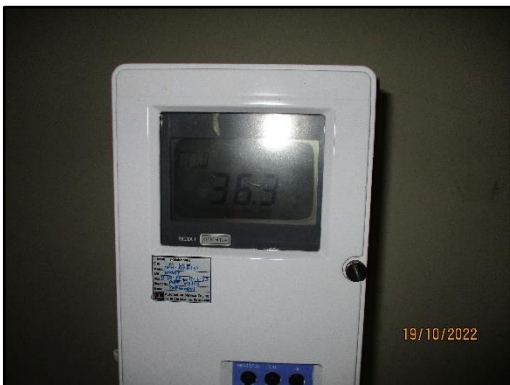
ภาพที่ 2.16 เครื่องตรวจวัดซีโอดีอัตโนมัติ (Auto COD) บริเวณรางระบายน้ำทิ้ง ก่อนลงสู่ห้วยโจด
