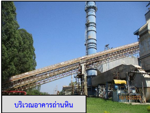
ภาพที่ 2.3 สายพานลำเลียงระบบปิด บริเวณลำเลียงถ่านหิน เศษไม้ และกากตะกอน
